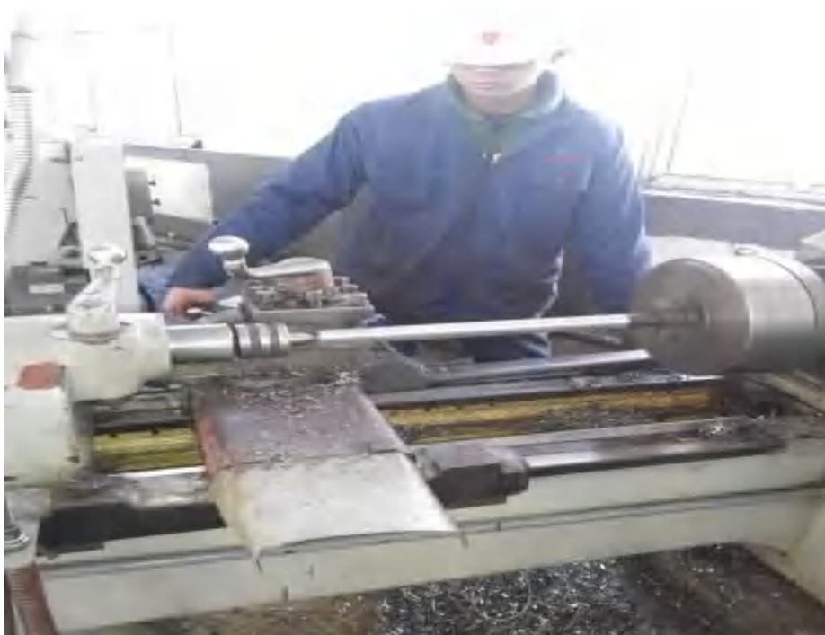
漏包拉杆加工
